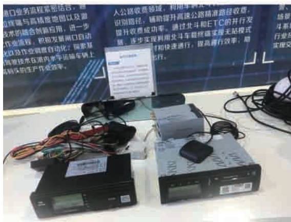
图24 道路运输车辆卫星定位系统高精度车载定位终端
