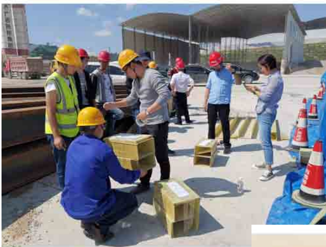
图 28 玻璃钢管箱产品 现场抽样
