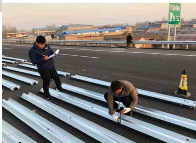
图 29 公路波形梁钢护栏产品现场抽样
