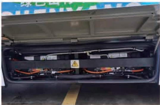
图 20 电动公共汽车电池仓
