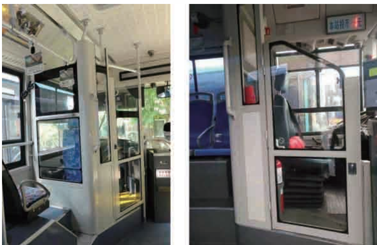
图9 公共汽电车驾驶区防护隔离设施设置
